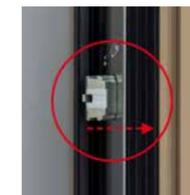
Automatischer Türöffner für Automatikschlösser (A-Öffner-Servo)
