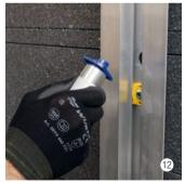
Vento Bohrlehre 15° vertikal, blau, befestigen mit einer viertel Drehung im Vento Hutprofil-Clip oder Vento Z-Profil-Clip.
