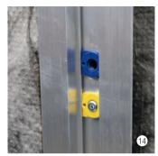
Vento Clip 15° vertikal, blau, befestigen mit einer viertel Drehung im Vento Hutprofil-Clip oder Vento Z-Profil-Clip.
