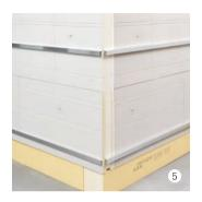
Vento Aluwinkel 29/40 satt in den horizontalen, dafür gefertigten Schlitz der Dämmung drücken (40 mm Schenkel in der Dämmung).
