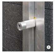
Vento Bohrlehre 0° gerade, gelb, befestigen mit einer viertel Drehbewegung im Vento Hutprofil-Clip oder Z-Profil-Clip.
