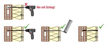
Bohren in Beton oder festen Untergründen kann mit Hammerbohrer besser: ausgeführt werden(siehe Hammerbohrer swisspor). Bohrloch immer vom Staub befreien mittels Ausblasoumpe (siehe Ausblasoumpe swisspor).
