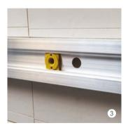
Vento Clip 0° gerade, gelb, mit viertel Drehbewegung in Vento Aluwinkel-Clip setzen.
