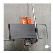
Exaktes Zuschneiden der Dämmplatten mit einem geeigneten Heissdrahtschneidegerät.
