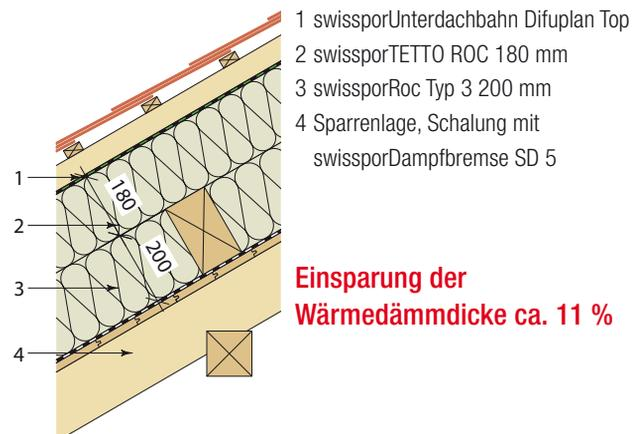
**Einsparung der Wärmedämmstärke ca. 11 %**
