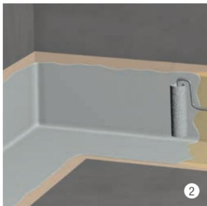
Neu abkleben und Einbettschicht mit Wecryl R 230 thix auftragen (ca. 1,5 - 2,0 kg/m<sup>2</sup>).
