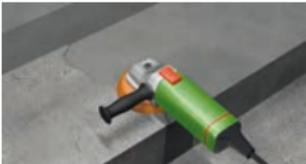
Eine auf die Schleifmaschine montierte ZEC-Scheibe kann zum Anschleifen von Blechen, Fensterrahmen, Holz und Beton verwendet werden. Darüber hinaus stellt handelsübliches Schleifpapier oder die Bandschleifmaschine eine ergänzende Möglichkeit dar.
