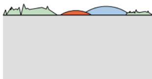
Um eine optimale Verbindung zwischen Harz und Untergrund zu gewährleisten, ist ein gründliches Reinigen der Oberfläche unablässig. Mit swisspor ECO Cleaner sind trennende Schichten wie z. B. Staub, Fette, Moos oder andere typische Substanzen zu entfernen.
