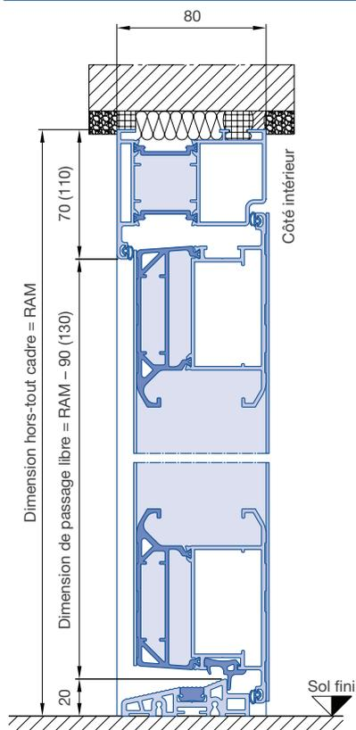
En cas d'exécution avec seuil standard, le profilé d'encastrement au sol/la protection de transport peut être démonté(e), afin de permettre le montage de la porte sur sol fini.
