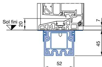
Encastrement au sol/protection de transport standard de la largeur de l'élément avec cornière d'extrémité de profilé PAD extérieure et intérieure (non monté) (compris dans le prix de la porte)
