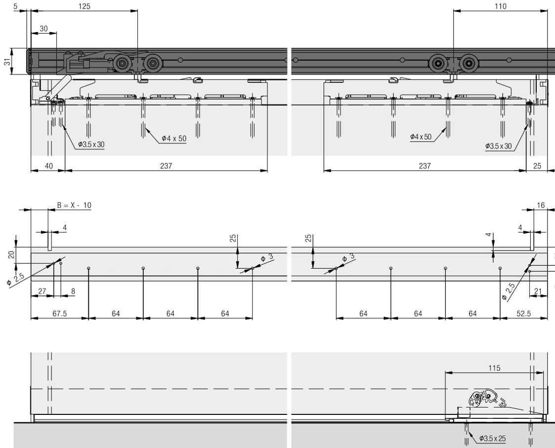
**Détail de montage du guidage au sol**
