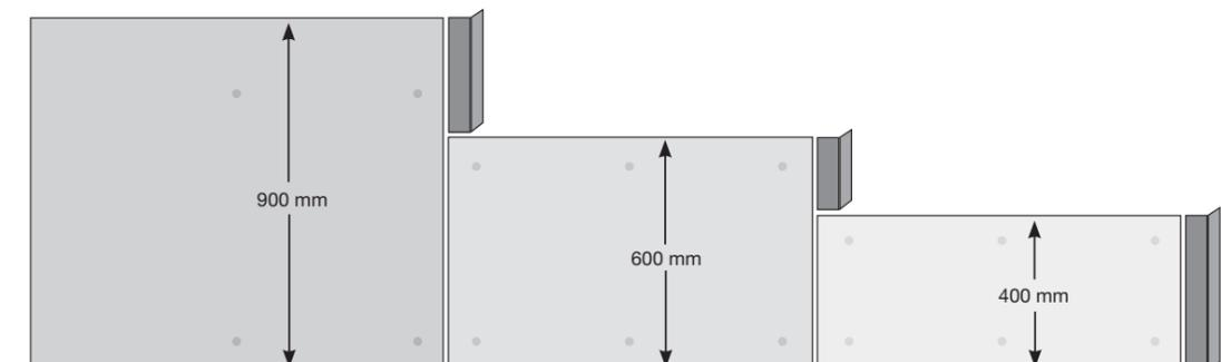
Raccordement des panneaux avec languette externe et couvre-joint en tant que bordure. Le couvre-joint est collé point par point.
