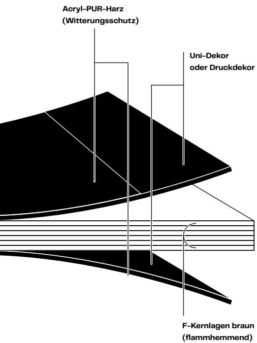
3 01 Aufbau Balkonbodenplatte
