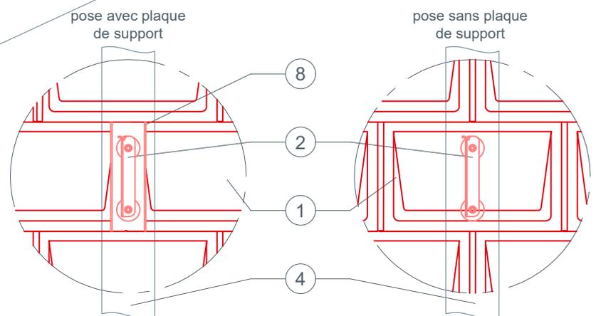
Pour les éléments de toiture de petit format, la pose d'une plaque de support peut être requise avant l'installation du support de pare-neige pour rondins. C'est le cas par exemple lorsqu'un joint se trouve directement au-dessus d'un chevron, à l'endroit où l'élément doit être monté.
