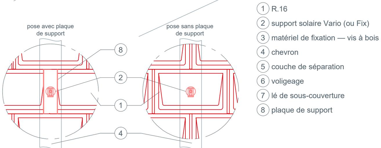
Pour les éléments de toiture de petit format, la pose d'une plaque de support peut être requise avant l'installation du support solaire Vario ou Fix. C'est le cas par exemple lorsqu'un joint se trouve directement au-dessus d'un chevron, à l'endroit où l'élément doit être monté.
