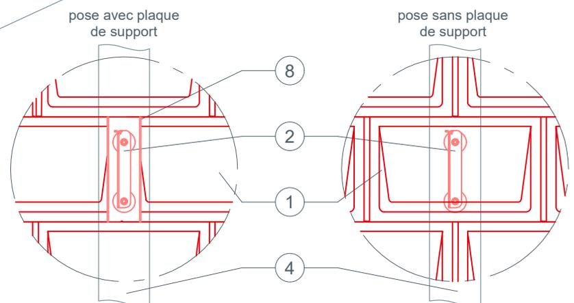
Pour les éléments de toiture de petit format, la pose d'une plaque de support peut être requise avant l'installation du système pare-neige. C'est le cas par exemple lorsqu'un joint se trouve directement au-dessus d'un chevron, à l'endroit où l'élément doit être monté.
