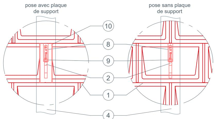
Pour les éléments de toiture de petit format, la pose d'une plaque de support peut être requise avant l'installation du crochet de sécurité. C'est le cas par exemple lorsqu'un joint se trouve directement au-dessus d'un chevron, à l'endroit où l'élément doit être monté.
