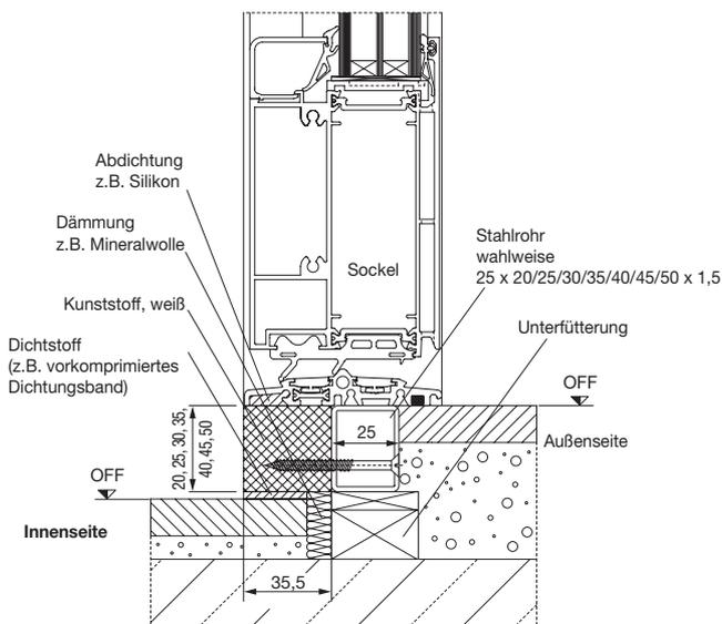
optimal für Türmontage bei Höhenversatz zwischen Außen- und Innenfußboden
