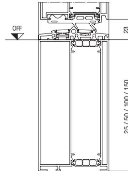
Bodeneinstandsprofil aus Aluminium
