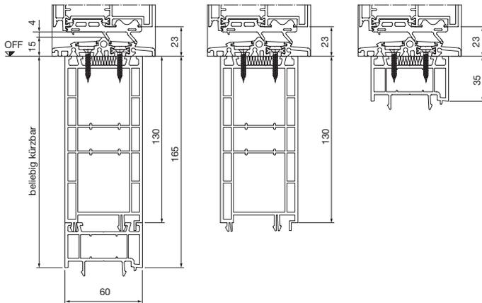
Bodeneinstandsprofil aus Kunststoff, kombinierbar, lose, bauseitig kürzbar
