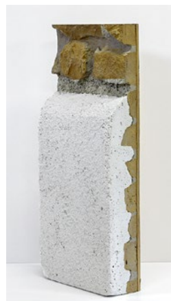
Le crépi isolant, qui s'adapte à la forme, assure un joint sans cavité avec la maçonnerie.
