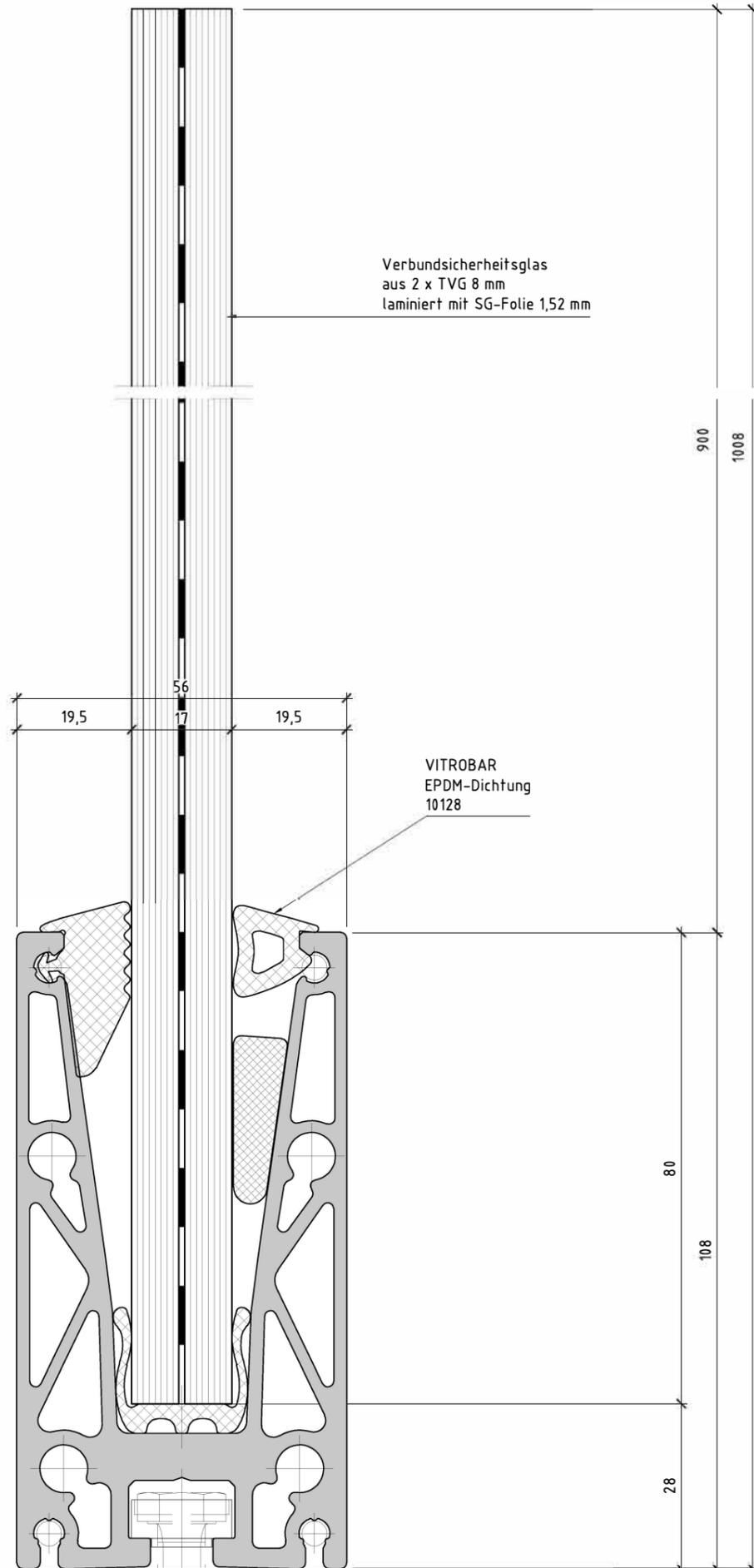
**Vertikalschnitt V4OS - M1:5**
