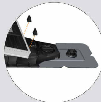
Detail #6 Modulsicherung unten
