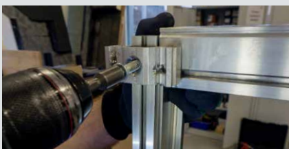
6 Querschienen an Klemmen oben und unten schrauben
