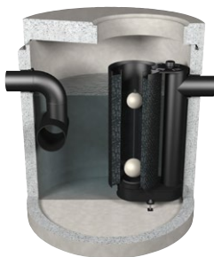
friwa®-sep Mineralölabscheider mit Koaleszenzfilter und selbsttätigem Abschluss (MAKS).
