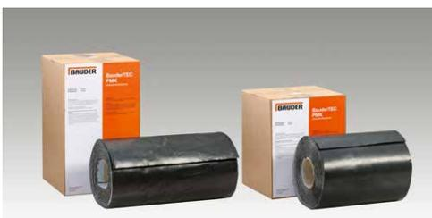
Einseitig selbstklebende Spezialbitumenbahn zum Abkleben von Schnittstellen bei BauderPIR Steildach-Wärmedämmelementen und BauderTOP-Bahnen, z. B. im Bereich von First, Grat, Kehle oder Anschlüssen usw.
