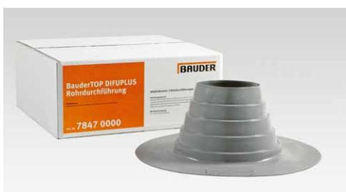
Vorgefertigte Manschette für die Abdichtung von Durchdringungen in den Grössen zwischen  $\varnothing$  80 – 120 mm, für Dächer bis 25° Neigung
