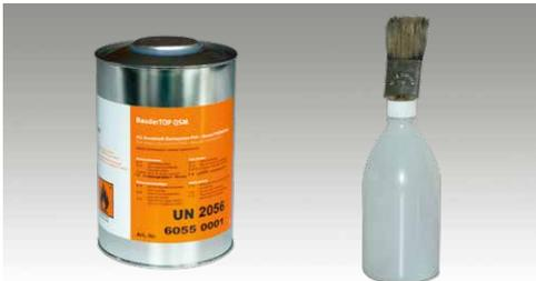
Solution liquide pour une soudure homogène pour membrane BauderTOP DIFUPLUS. Utilisation dès 5°C, température d'utilisation optimale 18 – 20°C. Bouteille à pinceau Bauder permettant une application aisée de la solution liquide de soudure.
