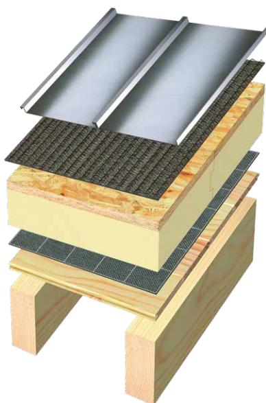
**Exemple de configuration BauderPIR MDE sous-couverture métallique:** Chevron apparents, lambris bois, lé pare-vapeur BauderTOP TS 40 NSK, BauderPIR MDE, couche de séparation BauderTOP VENT NSK
