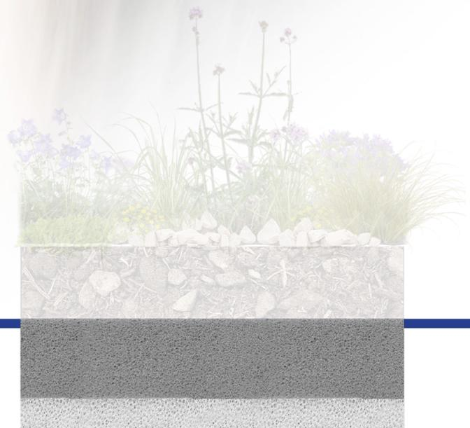
VIRIdiVITA premium roof ist ein Wasserspeicher, welcher das aufgesaugte Wasser vor Ort in den natürlichen Kreislauf zurückgibt. Die dabei freigesetzte Verdunstungskühle verbessert unser Mikroklima. Der Wasserspeicher wurde speziell für eine hohe Wasserrückhaltekapazität bei gleichzeitiger Durchwurzelbarkeit entwickelt.
