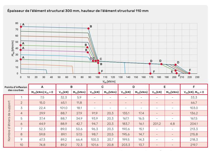
Tous les diagrammes de dimensionnement et les tableaux se rapportent à un type de béton C25/30 et à un enrobage de béton de 30 mm.
