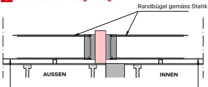
Untere Bewehrung einfügen und mit FIRIKA®-Anschlusselement binden
