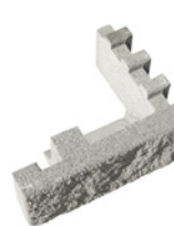
Eckteil E gebrochen 50/42/20 cm, 27 kg Farben: grau Rechte und Linke werden alternierend eingebaut
