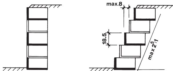
Böschungssicherungen können senkrecht oder bis maximal 70° Neigung ausgeführt werden.
