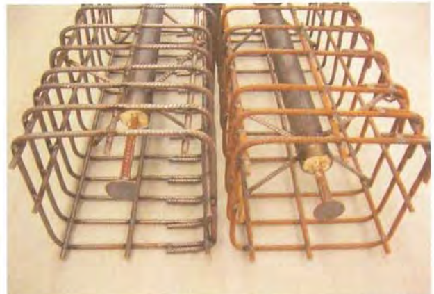
Armierung Ø 14 mm, Verankerung 10 Ø (links) und 5 Ø (rechts)
