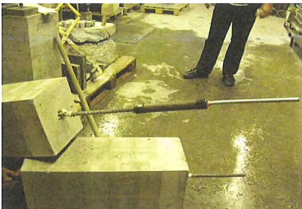
Prüfkörper 8507: Streckung Armierung und Auszug aus Beton
