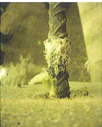
Prüfkörper 8507: Auszug aus Betonelement
