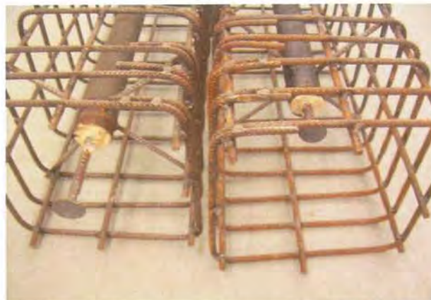
Armierung Ø 12 mm, Verankerung 10 Ø (links) und 5 Ø (rechts)
