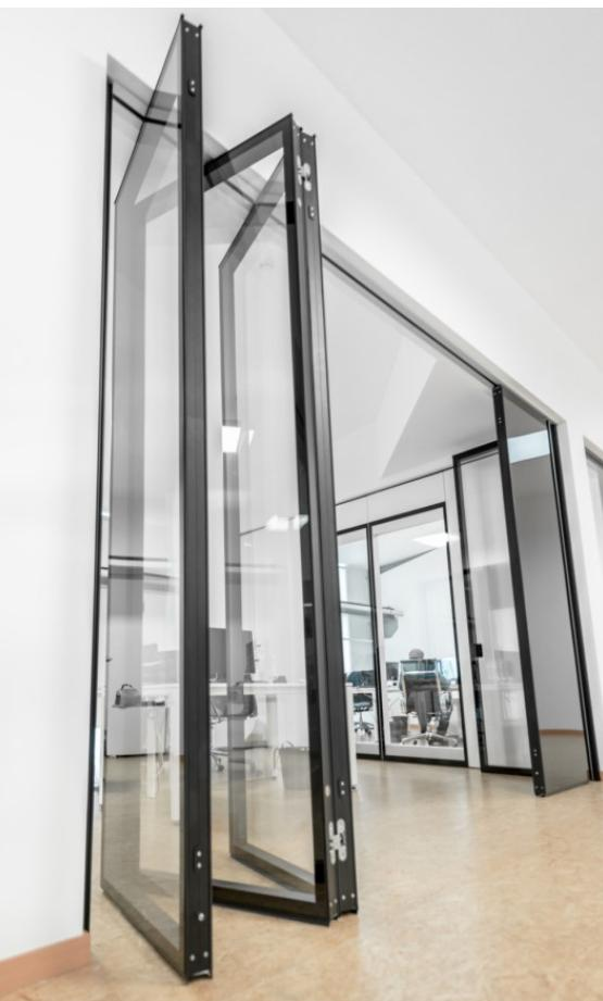
Die Schiebefaltwand WAVE lässt sich als Faltwand sowie auch als Schiebewand einsetzen. Dezente Rahmen lassen die Wand leicht erscheinen. Durch die Doppelverglasung erreicht die Schiebefaltwand bis zu 42 dB schalldämmwerte. Die Schiebewände werden in Eckschienen aus Aluminium ohne Bodenschienen geführt. Eine exzentrische Führung der Paneele mit nur einer geraden Schiene benötigen eine Bodenschiene zur Stabilisierung.
