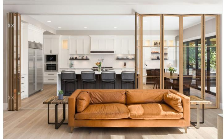
Die Schiebefaltwand VISTA lässt sich als Faltwand sowie auch als Schiebewand einsetzen. Dezente Rahmen lassen die Wand leicht erscheinen. Die Einfachverglasung erreicht leichte Schalldämmung bis zu 32 dB. Die Schiebefaltwände werden in Eckschienen aus Aluminium ohne Bodenschienen geführt. Eine exzentrische Führung der Paneele mit nur einer geraden Schiene benötigen eine Bodenschiene zur Stabilisierung.
