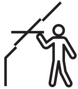
Schwingflügelfenster mit manueller, obenliegender Bedienung bieten die Möglichkeit, Möbel direkt unter dem Fenster zu platzieren, ohne die Bedienung des Fensters zu behindern. Wir empfehlen eine Einbauhöhe, die sowohl in stehender als auch in sitzender Position eine klare Sicht nach aussen ermöglicht. Bitte beachten Sie, dass die optimale Fensterhöhe von der Dachneigung abhängt.
