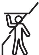
Die manuellen Klappflügel Fenster mit Oberbedienung öffnen sich nach aussen und bieten einen ungehinderten Panoramablick. Um die Klappfunktion voll ausnutzen zu können, empfehlen wir eine Einbauhöhe, die sowohl von einer stehenden als auch von einer sitzenden Position aus eine klare Sicht nach aussen ermöglicht. Bitte beachten Sie, dass die optimale Fensterhöhe von der Dachneigung abhängt.
