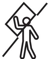
Das Fenster wird geöffnet, indem der seitliche Bediengriff gedreht und das Fenster nach aussen gedrückt wird. Im vollständig geöffneten Zustand wird der Fensterflügel durch den Öffnungsbegrenzer gesichert, um einen bequemen Zugang zum Dach zu ermöglichen.
