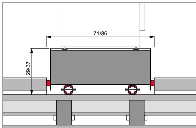
**Élément ergonomique****Dalle de construction légère avec chape**
