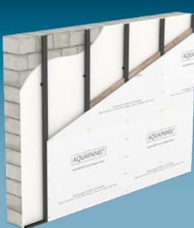
Das Vorsatzschalsystem **W683.ch** wird mit einer Unterkonstruktion aus Stahlblechprofilen CD 60/27, welche mit Direktabhängen/Direktschwingabhangern an der Grundwand befestigt werden, ausgeführt. Somit ist eine schlanke Bauweise in Verbindung mit grossen Wandhöhen realisierbar. Die Beplankung ist ein- oder zweilagig.
