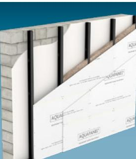
Das Vorsatzschalsystem **W686.ch** wird mit einer Unterkonstruktion aus Stahlblechprofilen CW als Einfachständer freistehend vor der Grundwand ausgeführt. Die Beplankung ist zweilagig.
