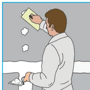
Alle Unebenheiten der Oberfläche abschleifen. AQUAPANEL® Q4 Finish in einer Breite von mind.
