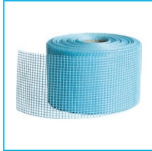
AQUAPANEL® Fugenband ist ein Glasgittergewebe mit alkaliresistentem Überzug. Es wird zur Armierung der Fugen verwendet und muss in den AQUAPANEL® Fugen- und Flächenspachtel - weiss eingebettet werden.
