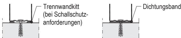
Randprofile an Boden und Decke befestigen. Wandanschlussprofile mit den flankierenden Wänden verbinden.
