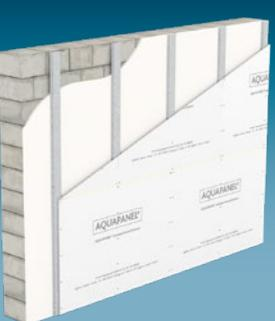
Das Vorsatzschalsystem **W684.ch** wird mit einer Unterkonstruktion aus Hutprofilen, die an der Grundwand befestigt werden, ausgeführt. Somit ist eine sehr schlanke Bauweise in Verbindung mit grossen Wandhöhen realisierbar. Die Beplankung ist einlagig.
