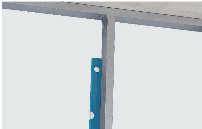
Bild 4: Ausrichten 1. und letzten UA-Profil
