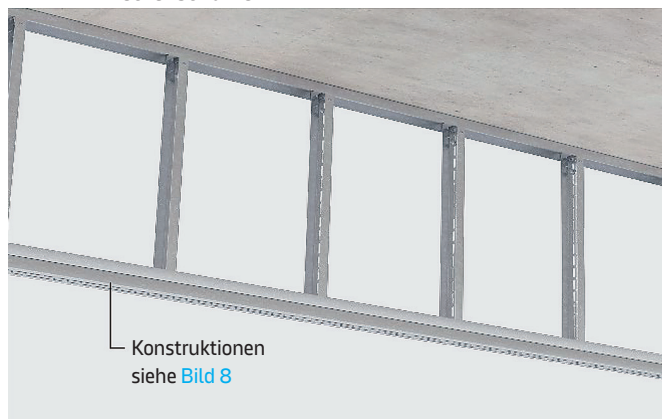
Bild 7: Montage UW-Profil-Konstruktion unteres Ende Deckenschürze
