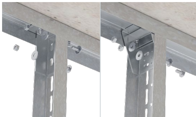
Bild 12: Ausrichten 1. und letzten UA-Profil
