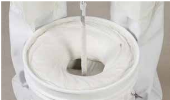
Aufrühren von Knauf Universalspritzspachtel mit dem Quirl.
