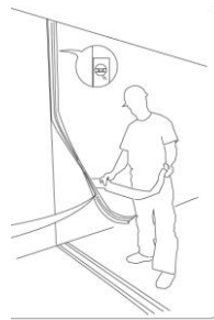
Montage des bandes périphériques
