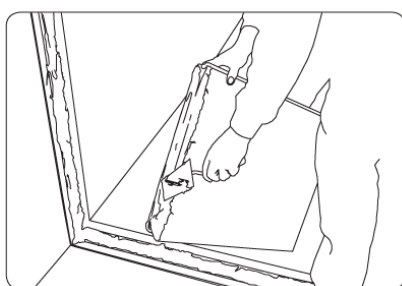
Application de la colle à plâtre
