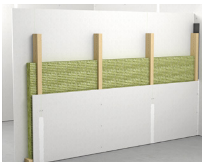
Anschließend Installationen einbauen und bei Bedarf das Gefach ausdämmen.
