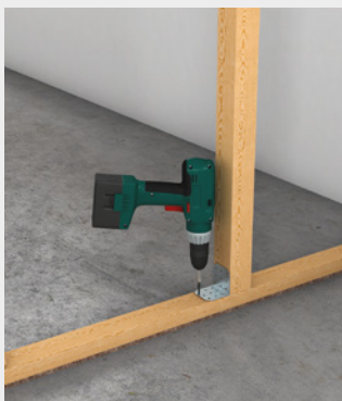
Montage der Holzständer mit Stiftnagel oder Stahlwinkel
