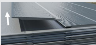
Hardie® VL Plank Platten werden ineinander gesteckt geliefert. Fassadenpaneele sind bei der Entnahme von der Palette seitlich herauszuziehen und erst dann anzuheben.
