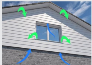
grün: Abluft blau: Zuluft
