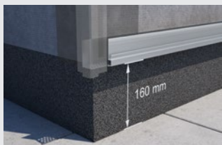
Befestigung des Starterprofils
