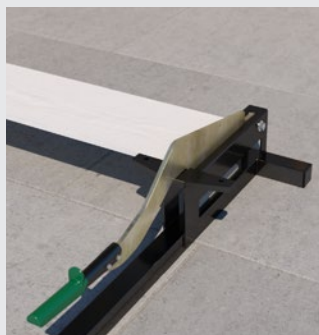
Lors de la découpe avec la Hardie™ Guillotine, la surface peinte doit être orientée vers le haut.
