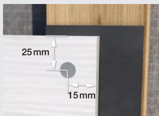
Schéma de fixation avec des clous
