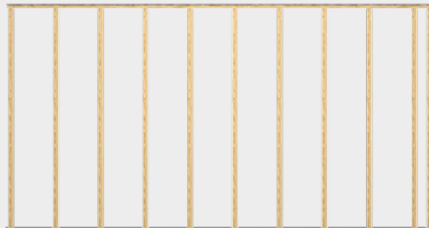
Achsabstand Unterkonstruktion max. 500 mm
