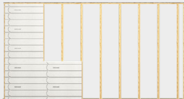
Montage der Therm25™ Elemente in Unterkonstruktion (Schrauben 40 mm oder Klammern 50 mm)
