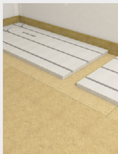
Verlegung der fermacell® Therm25™ Elemente lose verlegt, stumpf gestossen im Kreuzverbund
