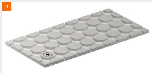
fermacell® Therm25™-125 Element rund, ergänzendes Element mit Fräsungen mit geringerem Rohrabstand für eine verbesserte Wärmeleistung, z.B. für Nassräume, Nutabstand 125 mm.
