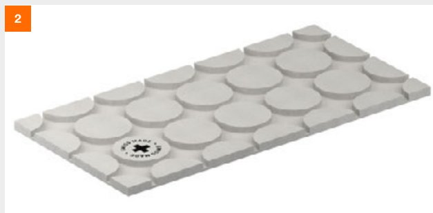
Plaque de sol fermacell® Therm25™ avec rainures en rond, pour une utilisation lors de configurations spéciales, pour les passages de portes ou devant le collecteur, écartement des rainures 167 mm.
