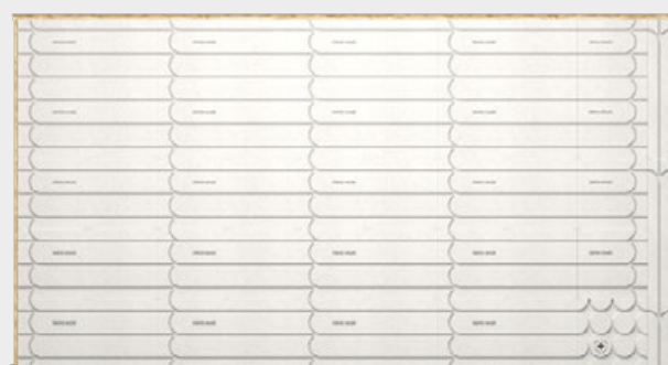
Poser verticalement une plaque en bordure de la surface pour assurer le passage du tuyau de chauffage
