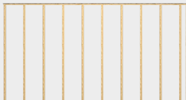
Entraxe de la sous-construction max. 500 mm
