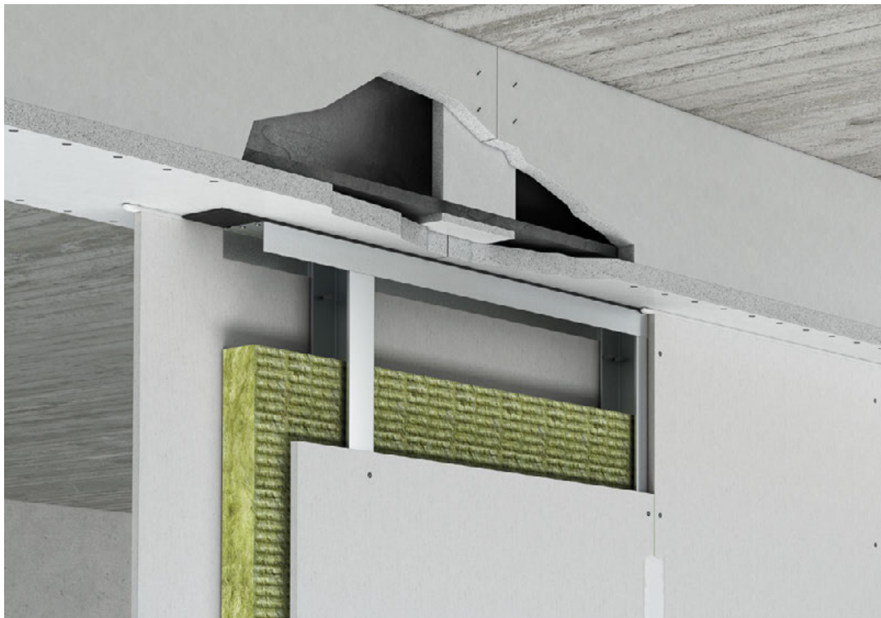
Detaillösungen Anschluss Trockenbauwand an bekleidete Stahlträger
