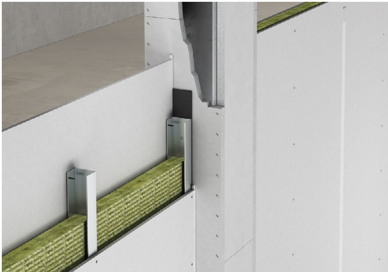
Detaillösungen Anschluss Trockenbauwand an bekleidete Stahlstützen
