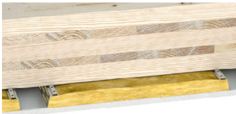
Massivholzdecke in Verbindung mit einer Unterdecke
