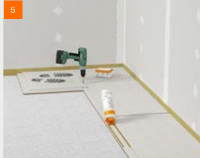
Verlegen der fermacell® Estrichelemente auf fermacell™ Ausgleichsschüttung
