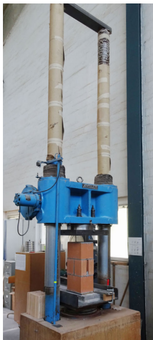
Druckfestigkeitsprüfung NUVO Wandlager mit Referenzsteinen
