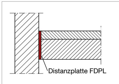
Eine optimale Körperschallisolierung wird erst erreicht, wenn keine Schallbrücken entstehen. Mit der Distanzplatte sichern Sie die Fugen und verhindern Verschmutzungen, z. B. bei Treppenpodesten und Treppenläufen.
