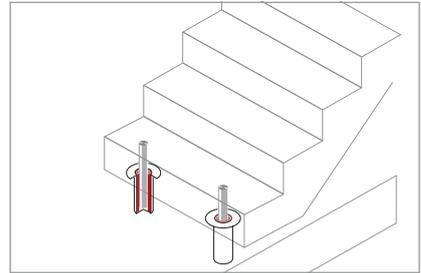
Zur akustischen Trennung des Treppenlaufs von der Bodenplatte bei gleichzeitiger konstruktiver Lagesicherung.
