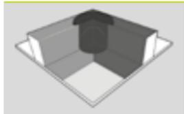
Vollflächiges Aufschweißen des oberen, waagerechten Eckzuschnittes
