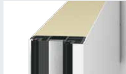
Hohe Wärmedämmung mit einem U-Wert von bis zu  $0,8 \text{ W}/(\text{m}^2 \cdot \text{K})$  durch das 65 mm dicke thermisch getrennte Türblatt
