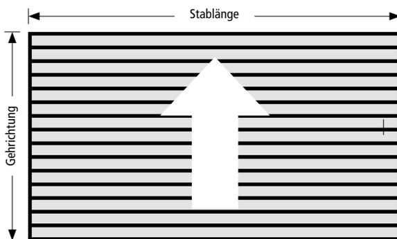
Die Eingangsmatte wird möglichst in einem Stück hergestellt. Größen, die in Abmessung und Gewicht zu unhandlich werden, müssen geteilt werden. **Maximale Länge und maximales Gewicht zur Herstellung ohne Teilung: Länge Aluprofile 300 cm, maximales Gewicht 50 kg.**
