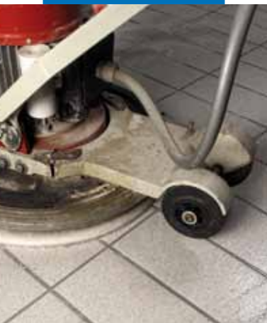
Reinigung der Flächen mit Wasser und einer Einscheiben-Reinigungsmaschine mit speziellen Padscheiben, z. B. Scotch-Brite®
