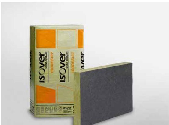
Halbsteife Fassadenplatte aus Glaswolle mit Schmelzpunkt > 1000°C nach DIN 4102, Teil17. Mit auflaminiertem, schwarzem Glasvlies und wasserabweisender Oberfläche. Bei Anforderungen an den Schmelzpunkt.
